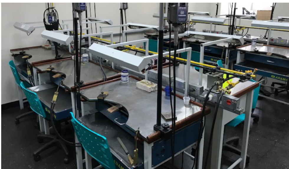
Instalações à mostra facilitam o controle e conservação das instalações de gases como o oxigênio, o argônio e o propano utilizados na produção de joias.
